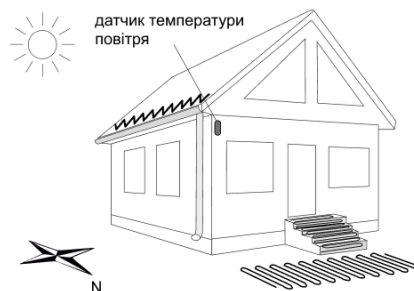
Рисунок 1. Монтаж датчика температури повітря
