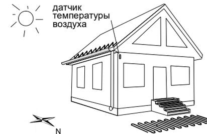
Рисунок 1. Монтаж датчика температуры воздуха
